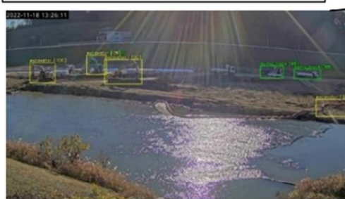
AIカメラによるダンプのリアルタイム入退管理
